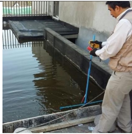
Inspector operando equipo SealingCheck DBP® sobre cover. Fig 1.5
