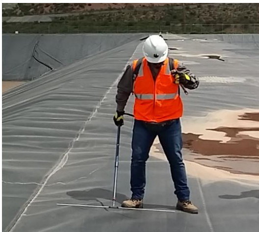
Inspector operando equipo Sealing Check DGEA® – ARC TEST Fig 1.1
